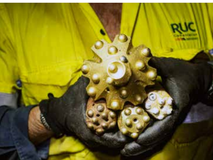
山特维克不仅为RUC提供设备、工具、零部件和技术支持，还帮助RUC重新磨锐了卡尔古利附近矿场中那些用钝的钻头。
