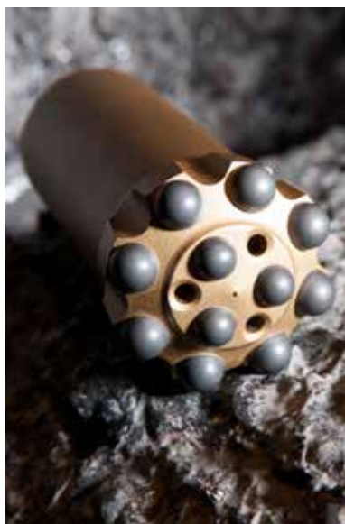
由于边齿数量增多，“顶部中心”钻头的使用寿命显著延长。
