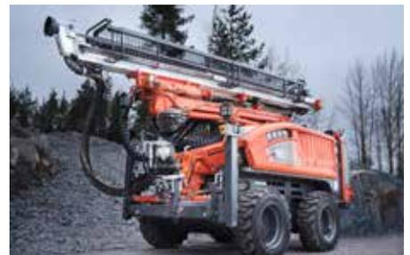
La Commando DC130Ri est une foreuse à système hydraulique, automotrice et entièrement télécommandée.
