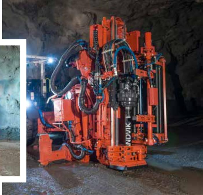
■ Avec la nouvelle foreuse Sandvik DU412i, l'exploitation minière souterraine va profiter de la flexibilité et de l'automatisme du forage fond de trou.
