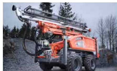
A Commando DC130Ri é uma unidade operada por controle remoto, hidráulica e autopropulsada.
