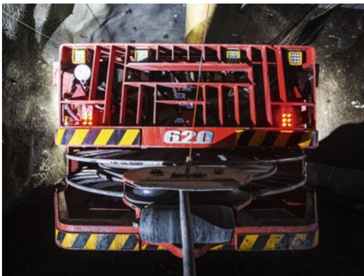
Одна из особенностей модели Toro LH625iE — заново спроектированная система намотки кабеля, призванная продлить срок его службы.
