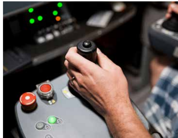
Chez Kidd Operations, chargement et déchargement sont pilotés depuis la surface grâce au système Sandvik AutoMine Lite.
