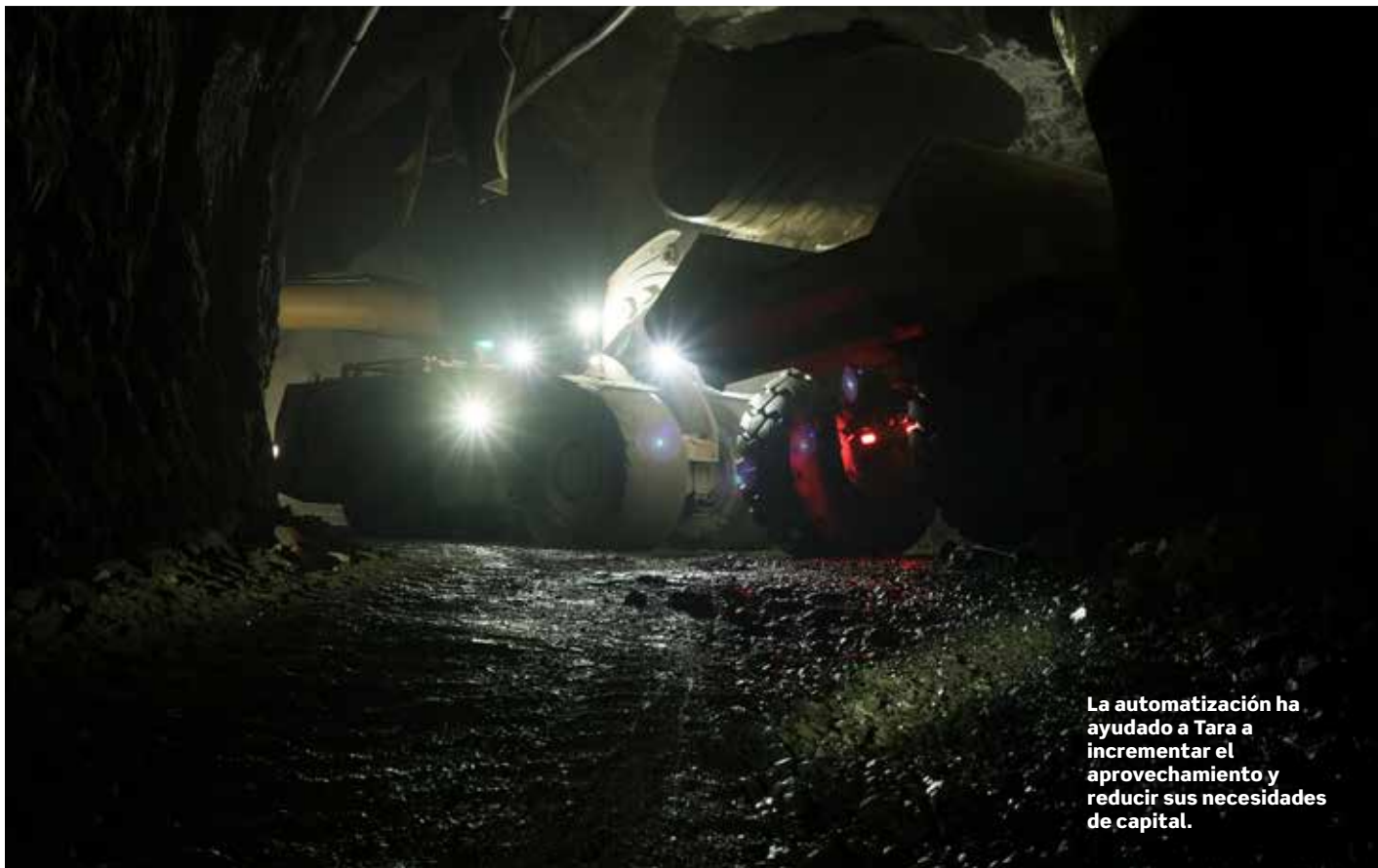
El operador Paul Finnegan controla su máquina a distancia desde la sala de control en la superficie.
