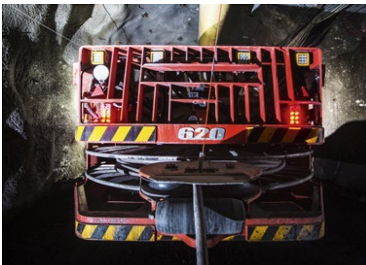
Toro LH625iE har även en uppdaterad kabelvinda som utformats för att öka elkabelns livslängd.
