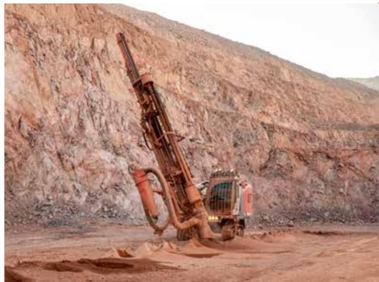
Deux foreuses fond de trou (DTH) connectées Leopard DI650i sont à l'œuvre dans la mine d'or à ciel ouvert de La Herradura. Le site fait également travailler deux foreuses Leopard DI550 DTH (ci-dessus).
