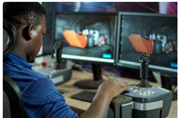
Au nouveau centre technologique de Sandvik au Zimbabwe, une équipe d'ingénieurs, d'analystes et de techniciens surveille le matériel via les outils numériques My Sandvik, OptiMine et AutoMine.
